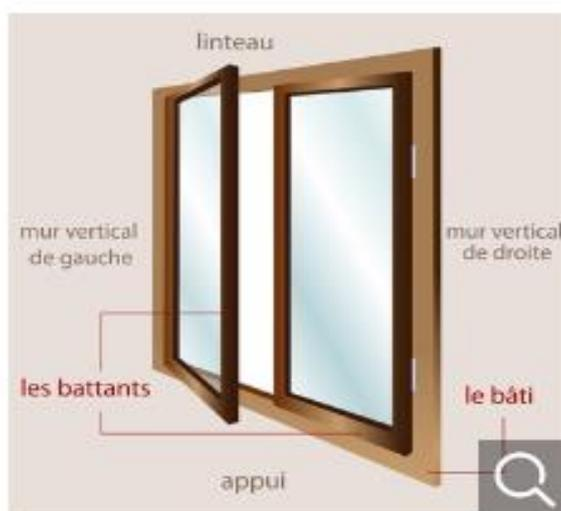
Le bâti de la fenetre (appelé aussi dormant ou cadre) correspond à l'encadrement. Il sera fixé dans la maçonnerie, donc solidaire du mur. Le bâti est la partie immobile de la fenetre.
